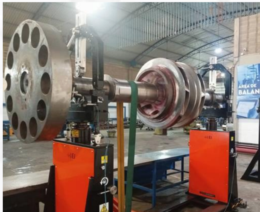
Balanceo dinámico del rotor de bomba centrífuga marca KSB modelo HE 700-98/2 Peso: 2750 Kg.
