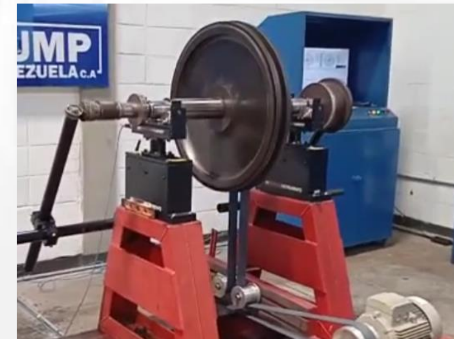
Balanceo de rotor de turbina de vapor modelo W182439-901. Peso del rotor: 202.2 Kg.
