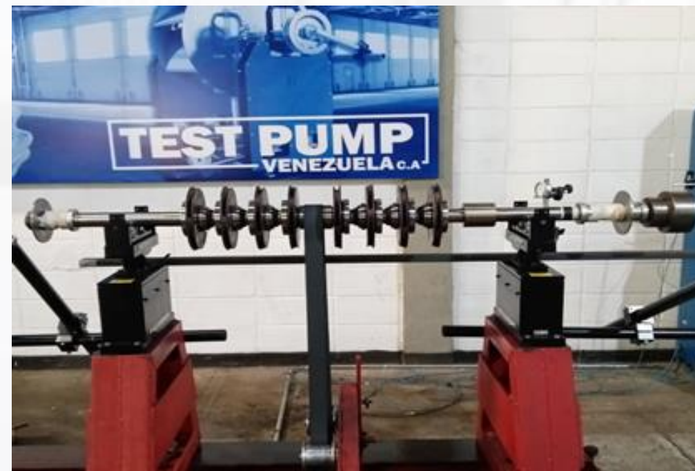
Balanceo de rotor de bomba multietapas modelo 3-UHX-9. Peso del rotor: 91 Kg.
