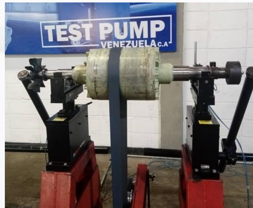
Balanceo de rotor de motor eléctrico tipo horizontal marca Reliance Electric Peso del rotor: 69,9 Kg
