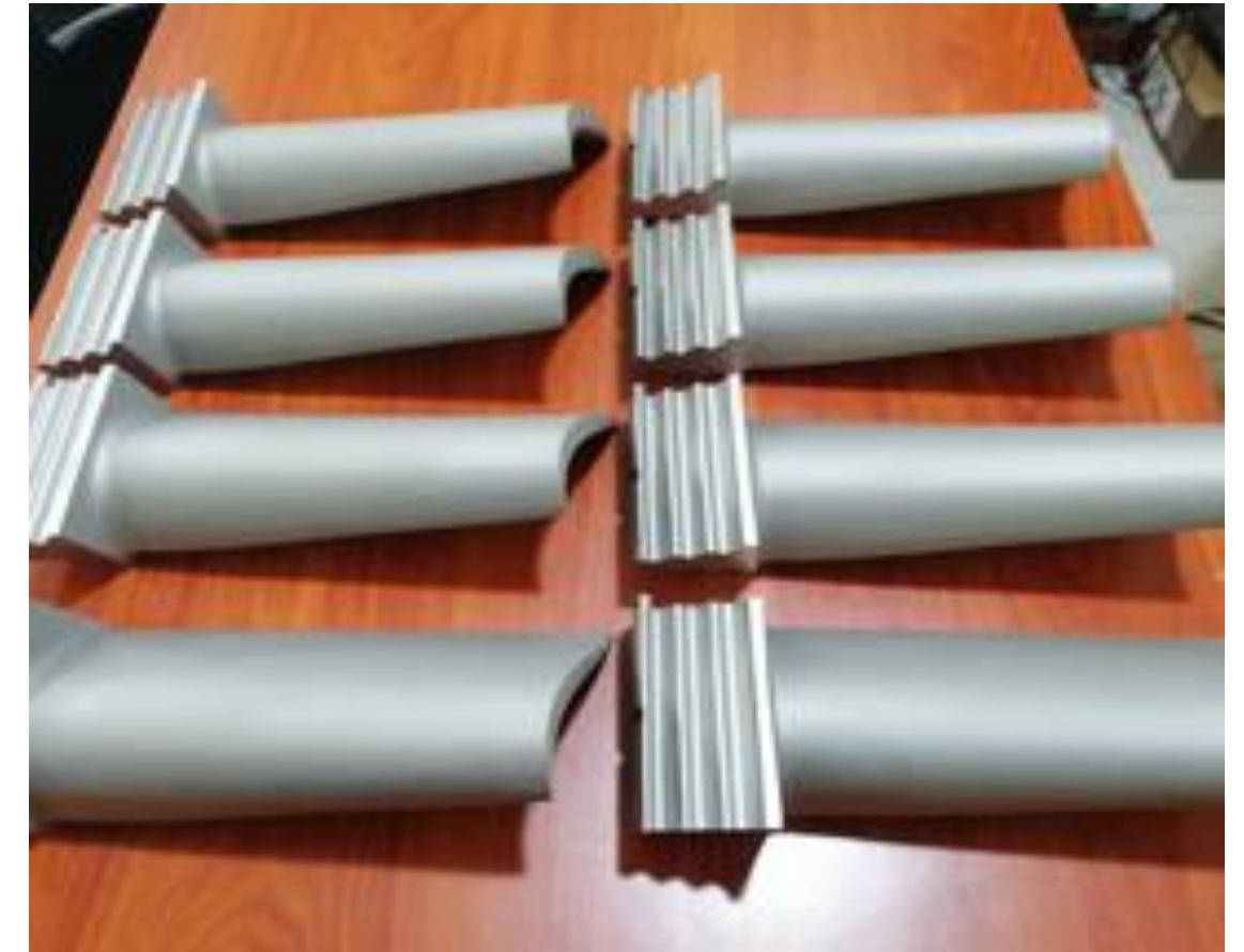
Álabes fabricados luego del desarrollo de la ingeniería inversa, Turbo Expansor
