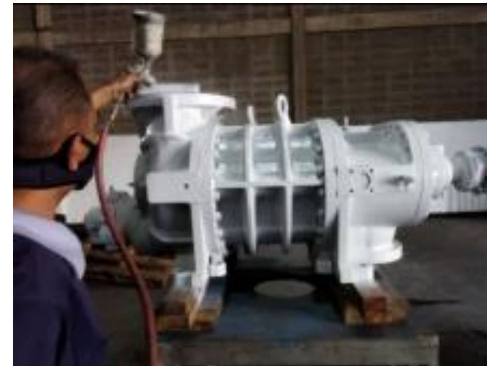
Compresor completamente reparado
