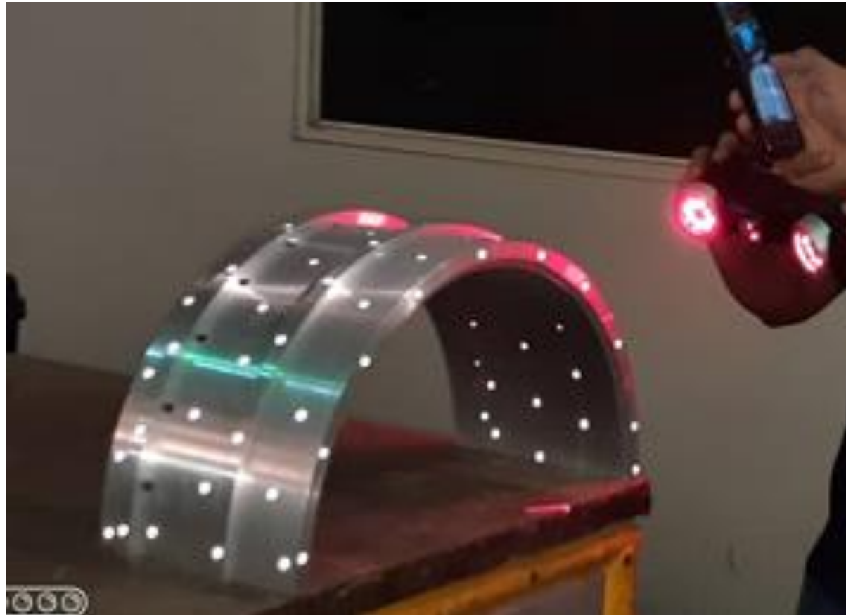
Escaneado del sello de gas de un compresor de gas marca HITACHI
